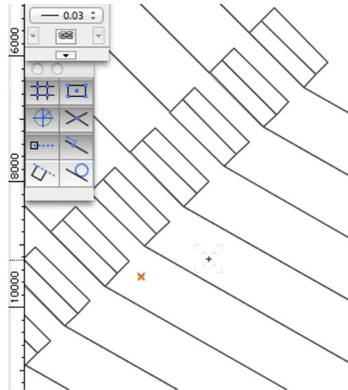
4. 接下来，选择在基本面板中的镜像工具。并在工具栏中选择第二模式，即复制模式。
