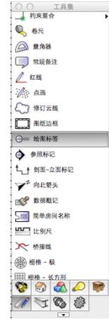
4. 在视口的底部中心点击一次去放置标签，然后向右移动光标，然后再点击一次鼠标去设置绘图标签的旋转方向
