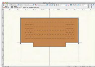
提示：在Vectorworks里创建混合(2D/3D)对象时，建议定时切换到3D视图来检查你的工作，因为有可能不知不觉地输入一个不准确的高度或者Z轴立面高度，而这些在俯视图/平面图视图中是不会被察觉到的。当在多个层中操作，在切换到3D视图前，你应当激活视图菜单下的“统一视图”。这个命令将把其它层和激活的层对齐，以便它们正确地显示在3D视图里。
