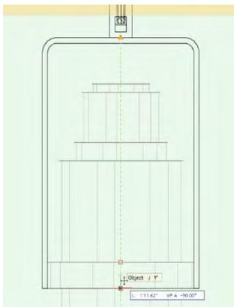
这将提示Vectorworks你希望灯钩和灯体围绕着哪一点进行轴旋转。如果你不增加3D轨迹，他们就会像灯钩一样围绕着插入点0,0,0进行旋转。
