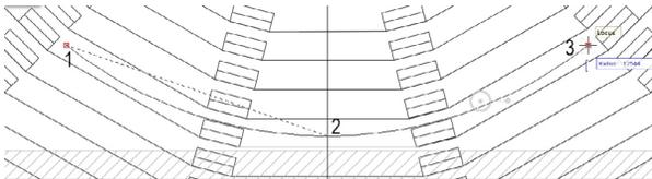
9. 默认情况下，吊杆被设置在该层平面的0位置上。为了提升灯杆高度，设置Z为7925毫米，然后按回车键。
