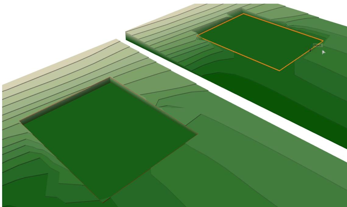
首先，我们将探索创建简单垫的过程。我们可以直接使用“场地修改器”工具，或通过“从形状创建对象”命令来创建垫，我们将在这个实例中转换矩形。
