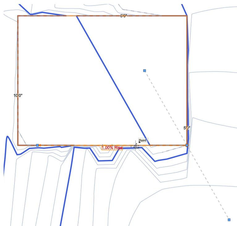
将修改器添加到场地后，就可以生成挖填计算。这要通过在对象信息面板中设置所需的单位，然后单击“更新挖填计算”按钮来完成。
