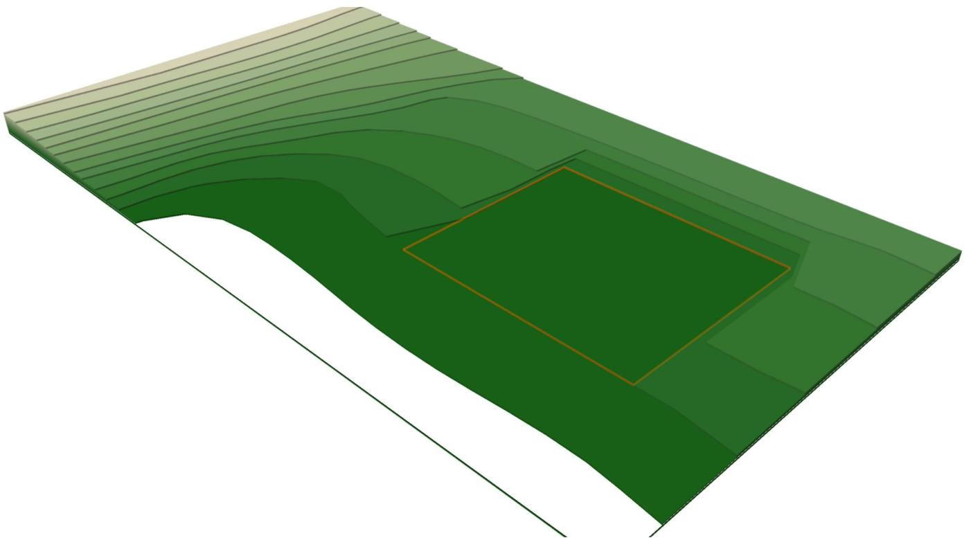
场地修改器被选定后，可以通过对象信息面板调整其设置。可以调整“旋转”、“简化耐阴性”、“配置”、“高度”、“斜率”以及应用的模型部分。任何更改都需要更新场地模型。例如，如果我们提高了垫的高度，我们将需要更新场地来查看更改。在仔细查看斜率选项和计算数据之前，让我们看看带挡土边的垫如何影响场地。
