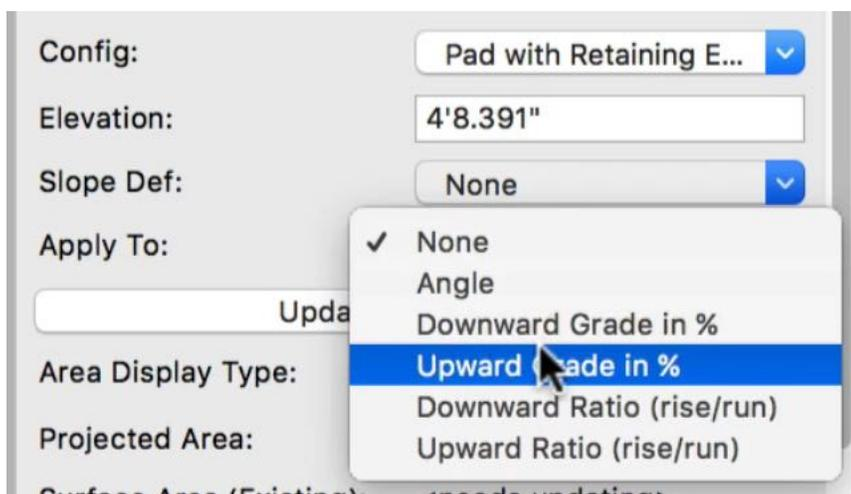
这两个修改器运用都相似，因此我们将在这个示例重点探讨常规的垫修改器。目前，这个垫没有斜率。要给垫一个斜率，只需在对象信息面板中选择“斜率定义”。斜率可以通过角度、向下或向上的坡度百分比或比率来定义。此选项仅控制斜率如何在修改器上显示。
