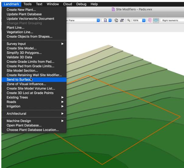
使用“发送到表面”命令，我们可以将挡土边移到场地的表面。我们希望在调整场地高度之前运行“发送到表面”命令，因此我们将撤消对场地的更新，以找回原始表面。现在，我们可以将挡土边发送到模型的原始表面。
