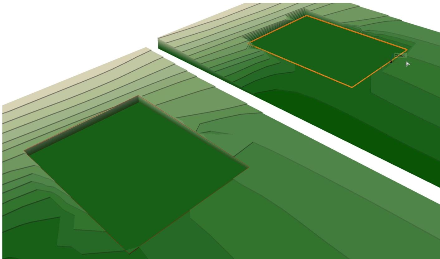
在这里我们可以真正发现区别。垫修改器调整场地没有任何限制，使标高下降到垫的高度。再看带挡土边的垫，看起来就像是对模型的一个干净切割，几乎像一个模型切割机去除了场地的一部分。如果仔细看这个修改器，我们可以看到这个对象实际上有两部分：
