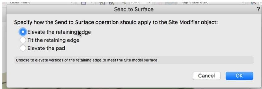
首先，我们可以提高挡土边——这将把挡土边缘的每个顶点发送到场地的当前高度，本质上，对象的每个点都将移动到正上方表面高度。
