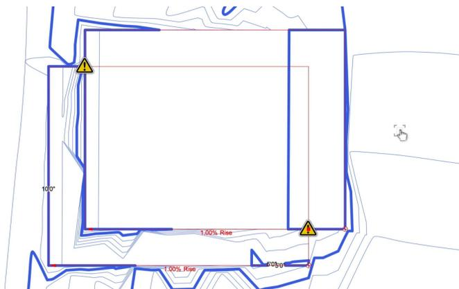
垫可以放在另一个垫的内部，但边界不应该接触或交叉。如果垫与另一个垫交叉，将发生“修改器冲突”。这会显示一个警告图标在场地上和对象信息面板中。垫的边缘可以接触另一个垫的边缘的唯一机会是当这两个边缘在同一高度时。
