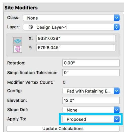
所以，先让我们确保这个垫被应用到拟建的模型。正如我们在对象信息面板中看到的，它当前设置为“拟建”。接下来，我们需要确保场地模型显示拟建的场地。要查看这一点，选择场地模型并查看对象信息面板中的二维和三维显示设置。我们会更改它们为显示“仅限拟建”。如果您不熟悉这些场地模型设置或现有与拟建场地模型之间的差异，暂停下来查看之前的“场地模型”章节。将垫设置为“拟建”并将场地模型显示也设置为“拟建”之后，就可以更新模型并查看更改了。选择场地模型并单击对象信息面板中的“更新”按钮即可。更新完成后，我们可以看到场地模型更新的二维表现。
