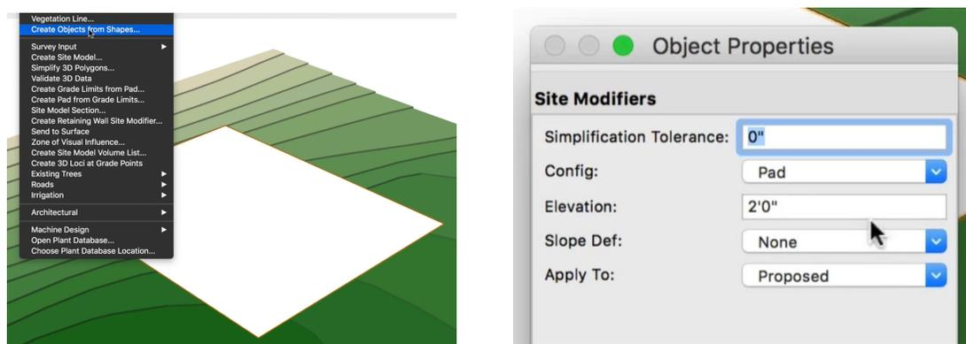
首先，我们需要启用垫。接下来，需要指定“高度”，或使用“捕捉到轮廓高度”模式来获得场地轮廓的高度。我们将使用这个模式为这个实例创建一个简单的矩形垫。
