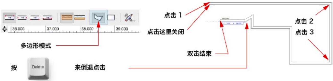
矩形模式下的墙工具和第一模式下的矩形工具（角落到角落）的点击相同。这种模式是Vectorworks软件的独有模式。大多数建筑物都有至少一个矩形房间，所以这是一个迅速、高效、准确的绘图方法，因为所需点击更少，角度被限制在90度，并且墙会智能地交互和自动连接在自动连接墙打开时。
