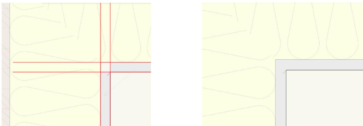
用“L连接”模式为这两个组件创建了一个斜接连接。
