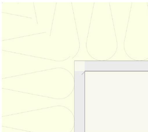
保持激活“组件连接”工具并启用“L连接”模式后，只需点击其中一个墙的内部石膏组件，再点击另一个墙的不同组件。
